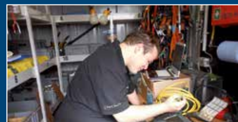
BGV A3 checks BGV A3 Prüfung
